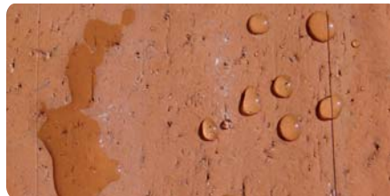
Lado Izq. sin proteger Derecho protegido con Nanoprotec®
